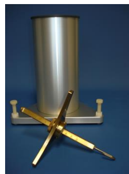
Bild 2 und 3: Beruhigungsrohr 73EB UG01 mit Einhängemesstab 73EB UG02
