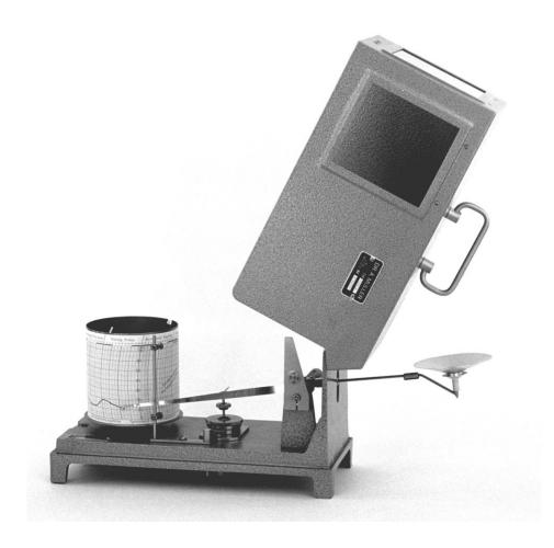
El rociógrafo tipo Keßler sirve para el registro de la precipitación de rocio, la cantidad del cual depende de la temperatura, del contenido del vapor de agua y del movimiento del aire, asi como de la temperatura de la superficie receptora, temperatura que, por su parte, depende de la radiación de la superficie.
