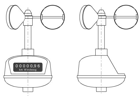
El contador llega a 99 999,99 km de recorrido máximo. Una unidad del último orden escrito representa 10m. Para fijar el aparato sobre una barra de acero el cubo de la cara inferior de la caja lleva una rosca interior de R $^{-1}/_2$ ". El anemómetro está construido contra salpicaduras y sus superficies están recubiertas de pintura extraordinariamente resistente a la intemperie, de color gris claro.
