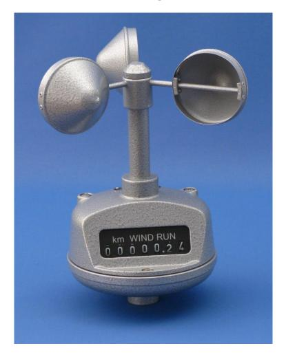
El gran anemómetro con contador 91ge, está resistente a la intemperie. Está sirve para medir la velocidad del viento en plena atmósfera y durante todo el tiempo que se quiera. Está construido para servicio permanente al aire libre, y dispuesto para la medida de las corrientes atmósfericas en altura a partir de 1,5 m hacia abajo. La ventana del contador está inclinada 30° hacia arriba. La altura de las cifras es de 8mm.
