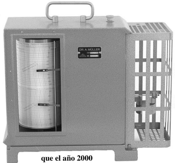
Con el aparato se facilita un paño humidificador destinado al control, reinstalación y regeneración del mismo. Se envuelve con él la regilla protectora con lo cual, al poco rato, se habrá alcanzado dentro del recinto así cerrado la saturación casi completa y la plumilla inscriptora debe señalar 96 %. Se puede corregir su posición mediante un tornillo de posición del cero.
