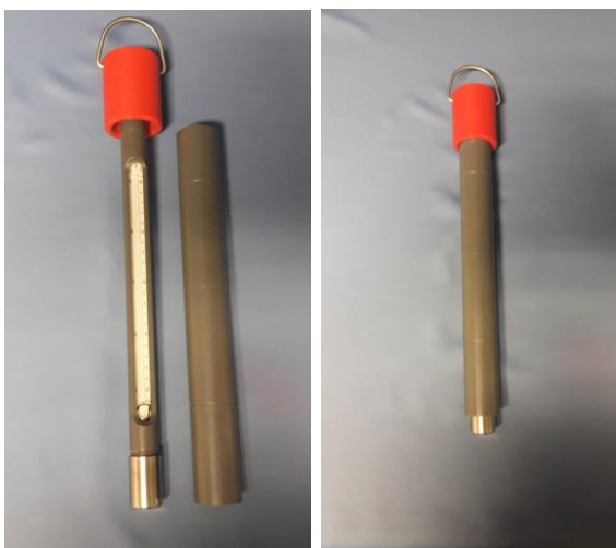
Bild 8 Erdboden Tiefenthermometer 61/30K für 10 / 20 und 30 cm Tiefe
